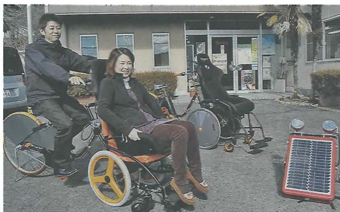
新たに開発した電動自転車。太陽光発電装置(右端)からも充電できる=御嵩町商工会で
